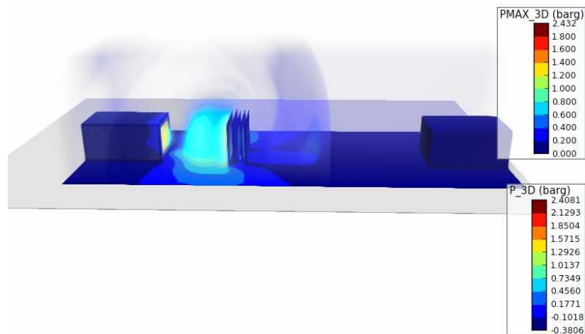
Рисунок 9 – 3d визуализация распространения избыточного давления на 0,440 сек
