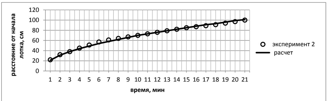
Рисунок Пб.1 – Положение «переднего фронта» фильтрационного потока от времени (неявный метод)
