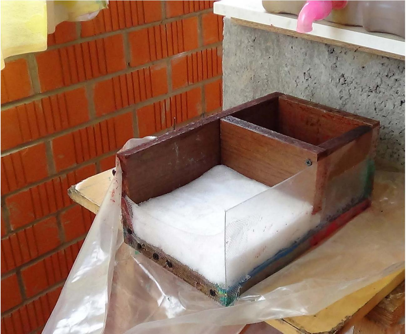
Рисунок П2.1 – Прямоугольный лоток для проведения опытов
