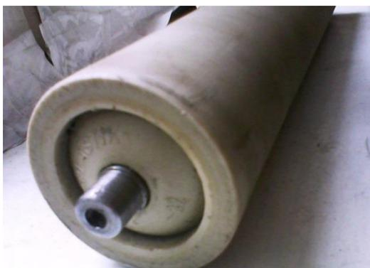
Рисунок 6.5 – Ролик полимерный конвейерный
