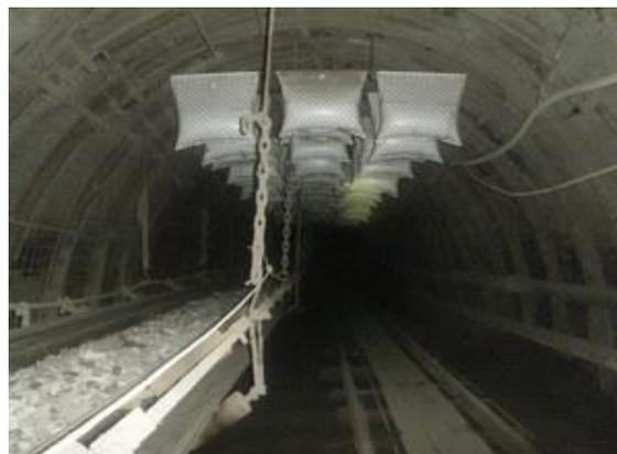
а – общий вид водяного мешка; б – водяной заслон в конвейерном штреке
