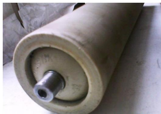
Рисунок 6.5 – Ролик полимерный конвейерный
